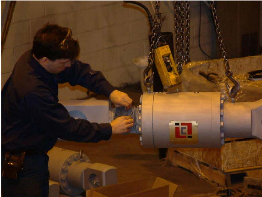
Figure 4 : Transmetteur en phase d'assemblage
